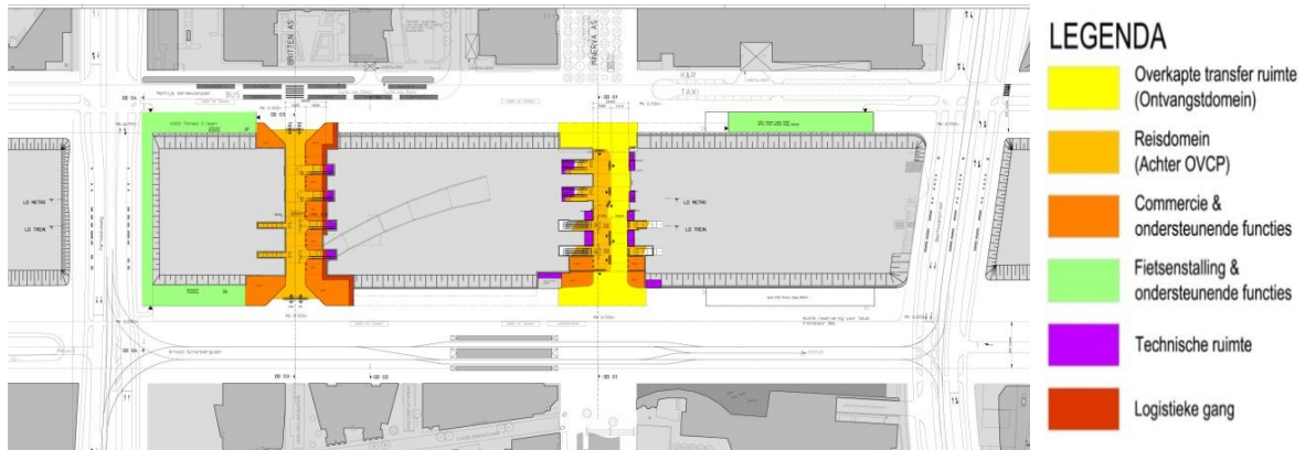
Afbeelding 8 Schematische weergave van het Basisalternatief OVT met Brittenpassage
