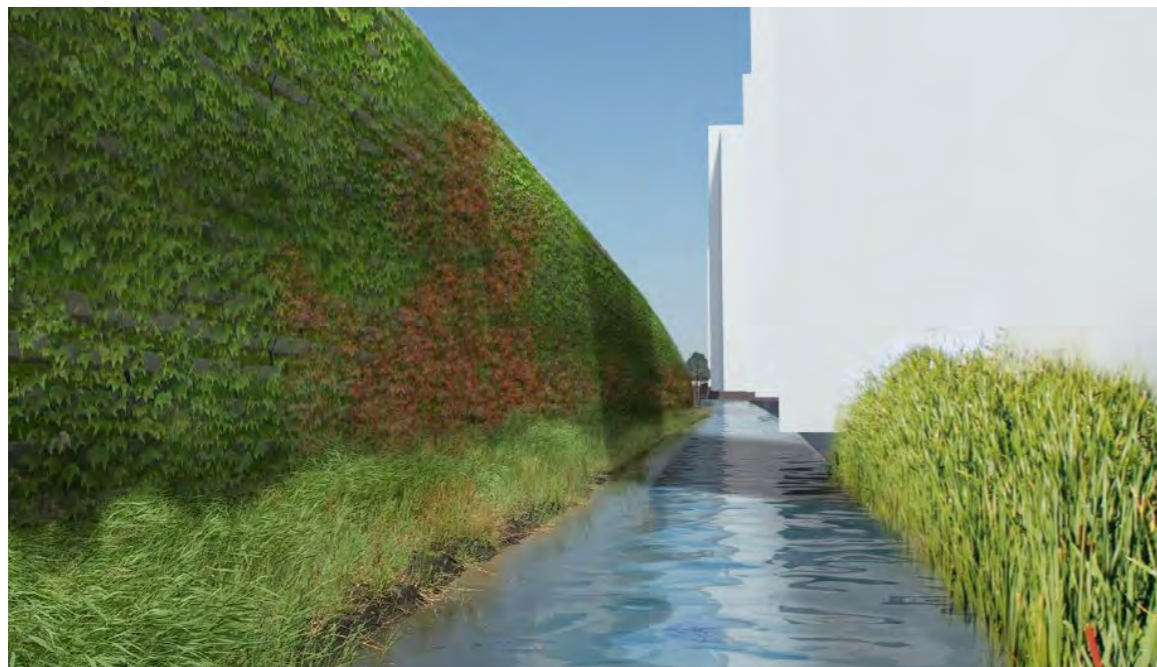
^ Impressie steile wand aan de stadzijde bij het Kenniskwartier: géén damwandprofielen maar robuust begroeide grondkerende elementen.
