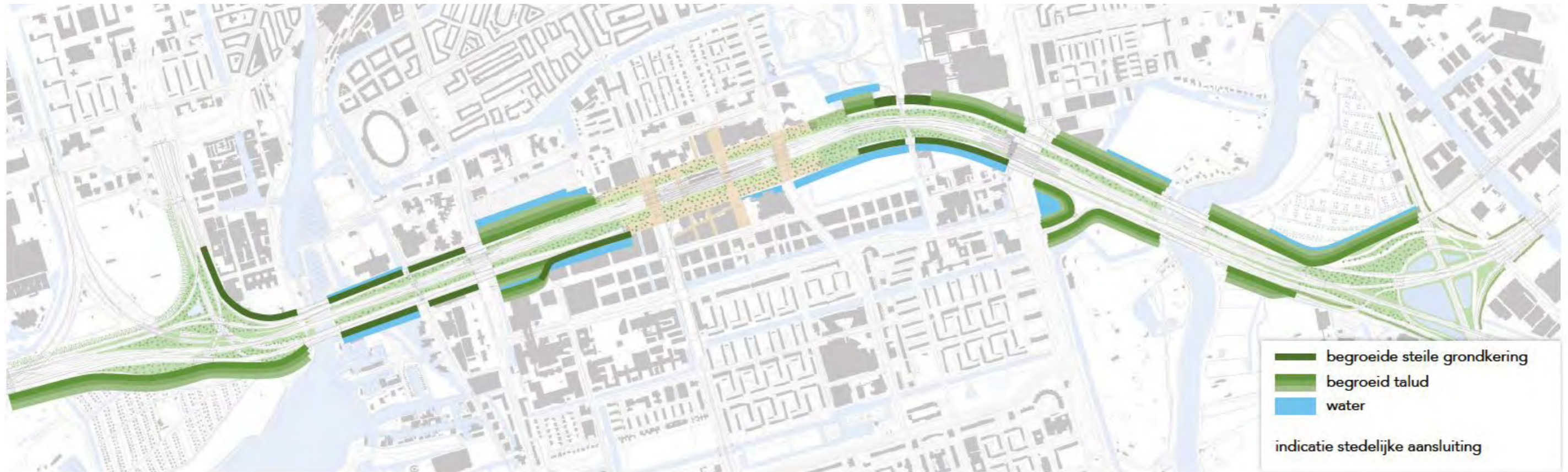
^ Indicatieve kaart met verschillende oplossingen voor de rand van het A10 Zuid tracé: aangegeven zijn de taluds (lichtgroen), steile wanden (donkergroen) en water (blauw).
