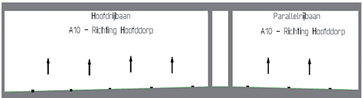
Figuur 9 Tunneldoorsnede rechts (=noord); hoofdrijbaan links en parallelrijbaan rechts.
