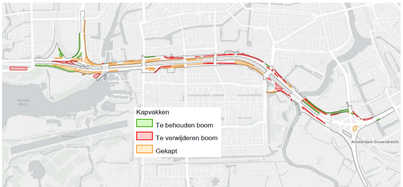
Figuur 7-2. Kapkaart van het plangebied van ZAD met daarin de kapvakken met te behouden bomen (groen), te verwijderen bomen (rood) of reeds verwijderde bomen (oranje).
