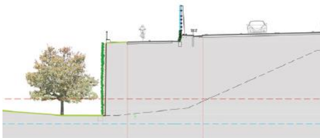
Figuur 18 Grondkerende constructie
