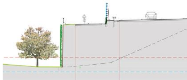
Figuur 8 Grondkerende constructie
