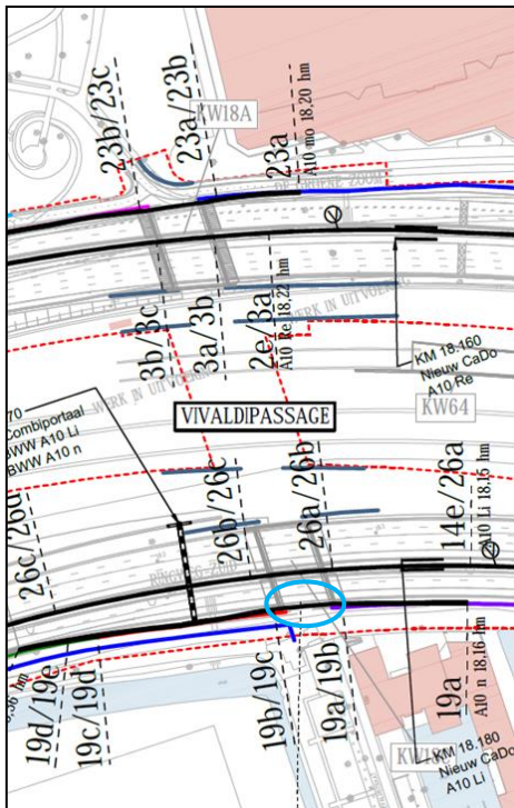
Figuur 9. Wijziging – Toepassen transparant scherm ter hoogte van Vivaldipassage
