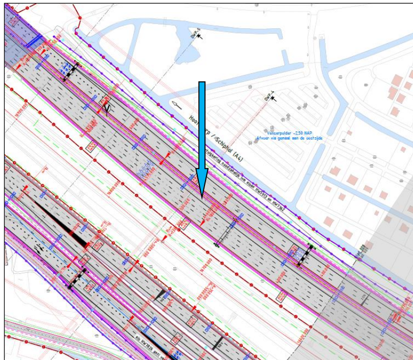
Figuur 7. Wijziging 2 - Realiseren vluchtstrook en daarop aanpassen positie geluidscherm en ligging parallelrijbaan, verbindingsboog en talud
